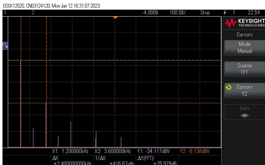
Figure 3.2 – Test d’ensemble – FFT de la broche « + » du module amplificateur
