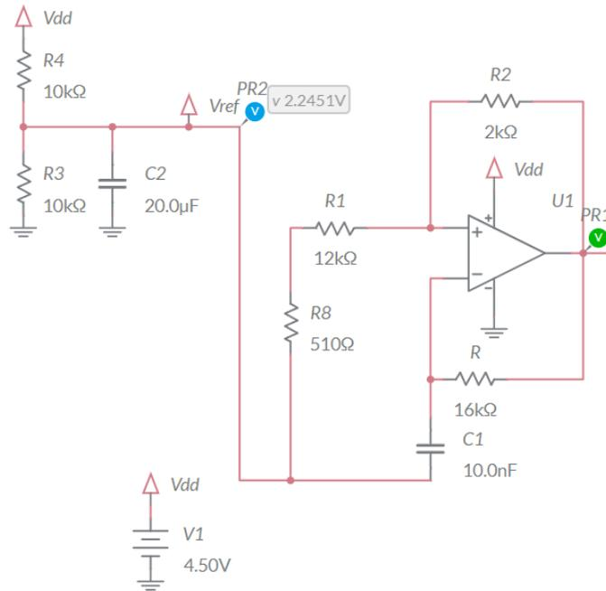
Figure 1.0 – Montage du multivibrateur astable à comparateur
